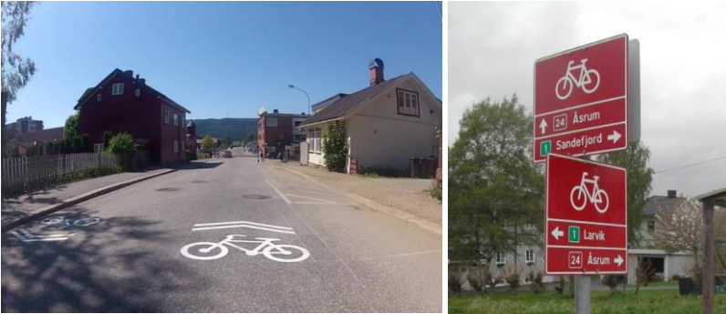
Figur 6-4: Eksempel på oppmerking med delingsymbol t.v. og skilting av sykkelrute t.h. (kilder: delesymbol https://www.tiltak.no/b-ende-transportmiddelfordeling/b-3-tilrettelegging-sykel/delesymbol-oppmarking-for-sykling-i-blandet-trafikk/ og skilting https://tfprod1.sintef.no/datakatalog/eksport/produktspesifikasjon-2.30/705.htm )
